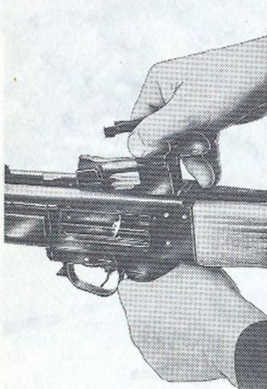
Sl. 58. Odvajanje nosača zatvarača
